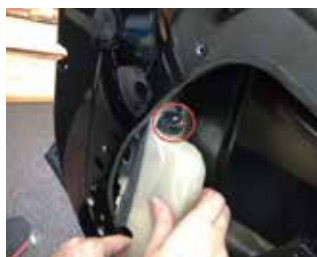
10.把原车锁插头拔掉，取出原车锁
