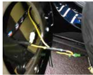
19.电吸锁插头线头对插我司电机
