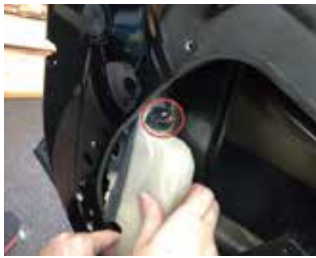
13.把原车锁插头拔掉，取出原车锁
