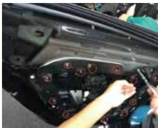
5.拆下盖板上的螺丝
