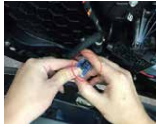
11.拆下盖板之后，把此处的插口插好，不然测试无法正常工作
