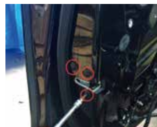
12.安装我司电吸锁，用我司螺丝固定
