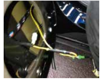
16.电吸锁插头线头对插我司电机
