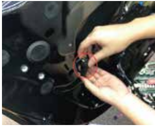
13.把原车锁的插口转插我司电吸锁插头
