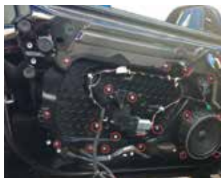
5.拆下盖板上的螺丝
