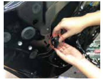
16.把原车锁的插口转插我司电吸锁插头
