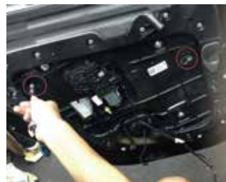
7.把玻璃降孔位上看到螺丝, 把螺丝拆下
