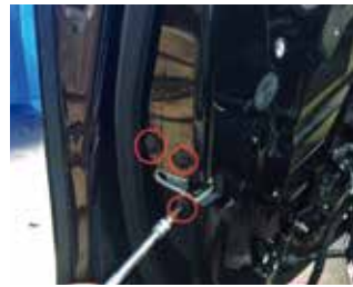
15.安装我司电吸锁，用我司螺丝固定
