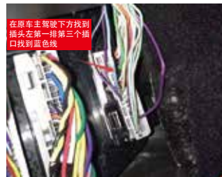
6.在原车主驾驶下方找到插头上蓝色线对接我司蓝牙协议线
