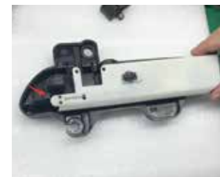
22.用螺丝加垫片把电机和拉线固定
