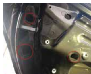
11.把原车车门上的防水胶塞拿下
