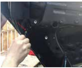
13.用螺丝刀把此处螺丝拆下
