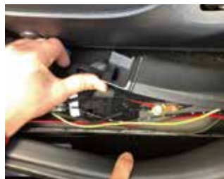
10.在原车主驾驶B柱下接地
