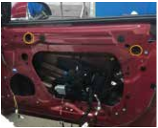
9.把原车上的防水胶拿下，把螺丝拆下
