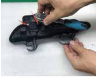
25.把原车把手上的螺丝拆下
