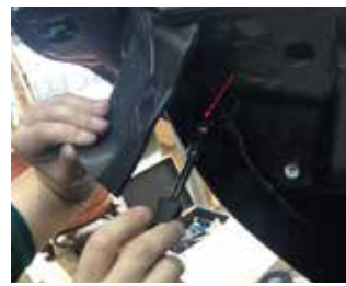
15.用螺丝刀把此处螺丝拆下
