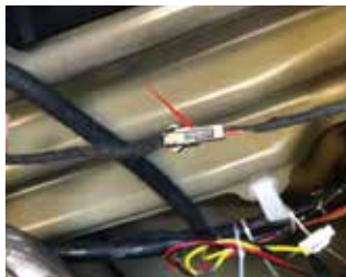
5.左右后门协议线对插 (左右一样)
