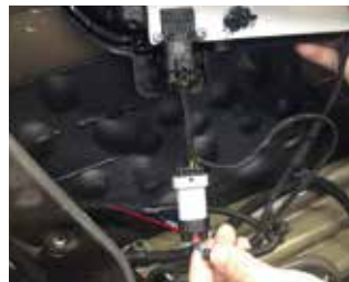
35.然后我司插头再插到原车插头上
