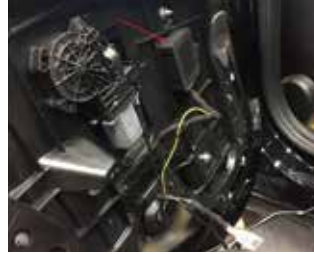
43.用防水胶把控制器固定在车门处
