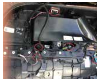
7.把盖板上的插口拔下,拆下盖板
