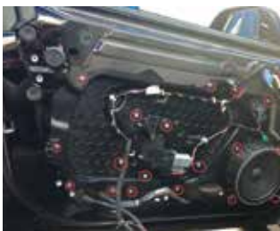
5.拆下盖板上的螺丝
