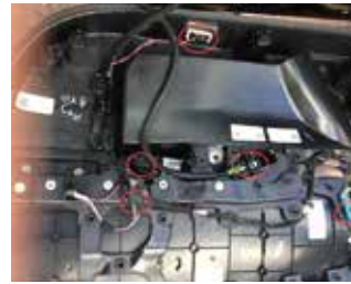
7.把盖板上的插口拔下，拆下盖板
