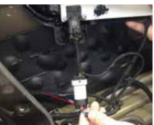
35.然后我司插头再插到原车插头上
