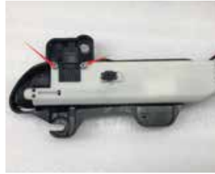
27.用原车螺丝把我司电机把手固定
