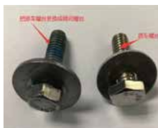
42.把原车螺丝更换成我司螺丝
