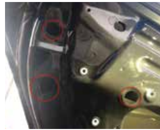
11.把原车车门上的防水胶塞拿下
