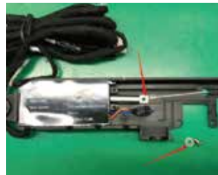
22.用螺丝加垫片把电机和拉线固定
