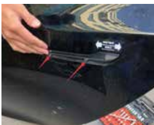
37.门把手对准下图的卡槽卡上去才能安装上去
