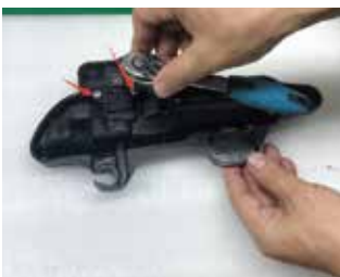
25.把原车把手上的螺丝拆下
