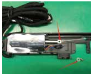
22.用螺丝加垫片把电机和拉线固定
