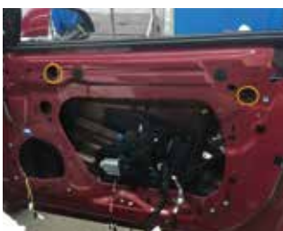
9.把原车上的防水胶拿下,把螺丝拆下
