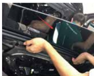
10.把原车上的玻璃拆下
