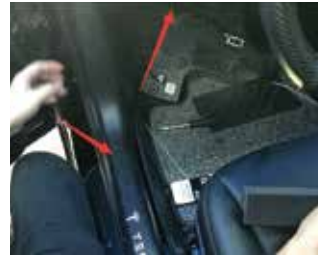
3.拆下原车此处饰板
