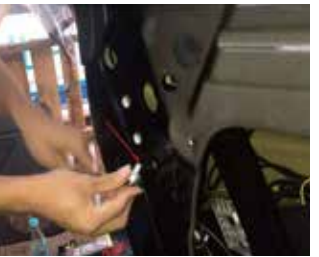
14.用螺丝刀把此处螺丝拆下
