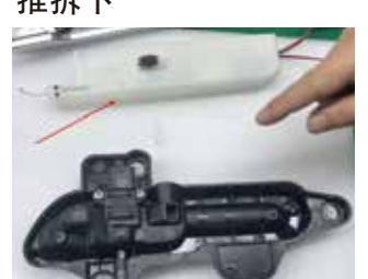
20.用螺丝刀把此处的往外推拆下
