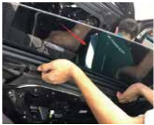
10.把原车上的玻璃拆下
