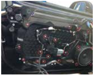
5.拆下盖板上的螺丝
