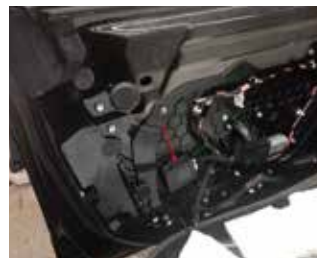
47.用防水胶把控制器固定在车门处
